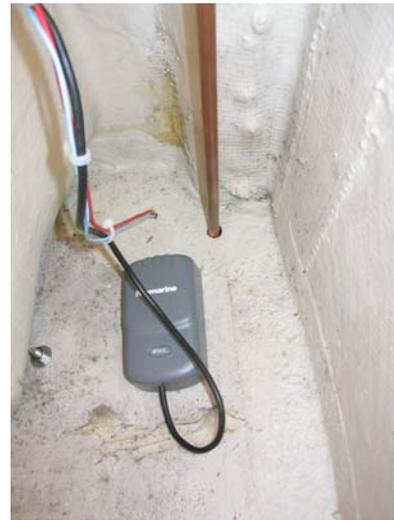
Sur la photo de droite on voit le quatrième boulon ainsi que le câblage de l'alimentation du pilote et le branchement à la base émettrice pour le boîtier sans fil de télécommande
