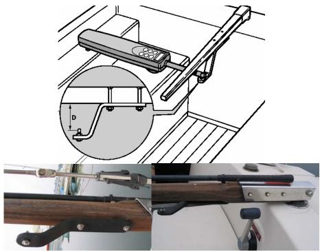
Pour fixer cette pièce sur la barre j'ai utilisé une perceuse sur colonne. Il est très difficile sinon de percer droit de part en part la barre.
