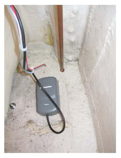
Sur cette photo on voit également le câblage de l'alimentation du pilote et le branchement à la base émettrice pour le boîtier sans fil de télécommande
